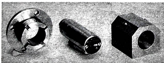
Bild 4. Differentialtransformator-Geber, Wegaufnahmen bis \pm 1 \text{ mm} , von Hottinger
